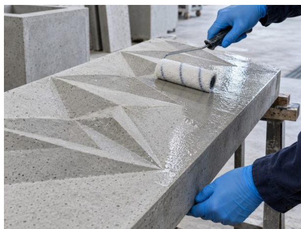
Finition de pièces béton décoratives exposées.
