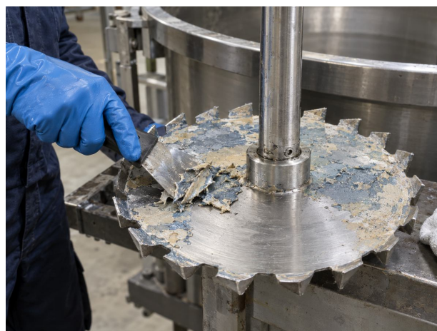
Décapage de dépôts polymères sur un disque de dispersion, en maintenance.
