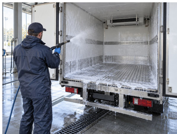
Nettoyage moussant d'un compartiment frigorifique en station de lavage.
