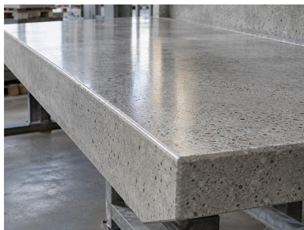
Vernis transparent sur une pièce de sol en béton apparent.
