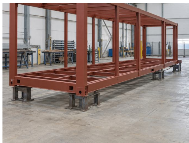
Primaire anticorrosion sur ossatures de modules.
