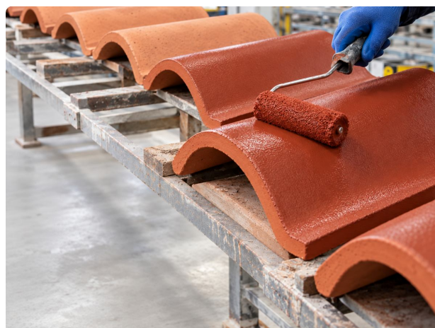
Application d'une peinture de couverture sur une tuile en terre cuite préparée.
